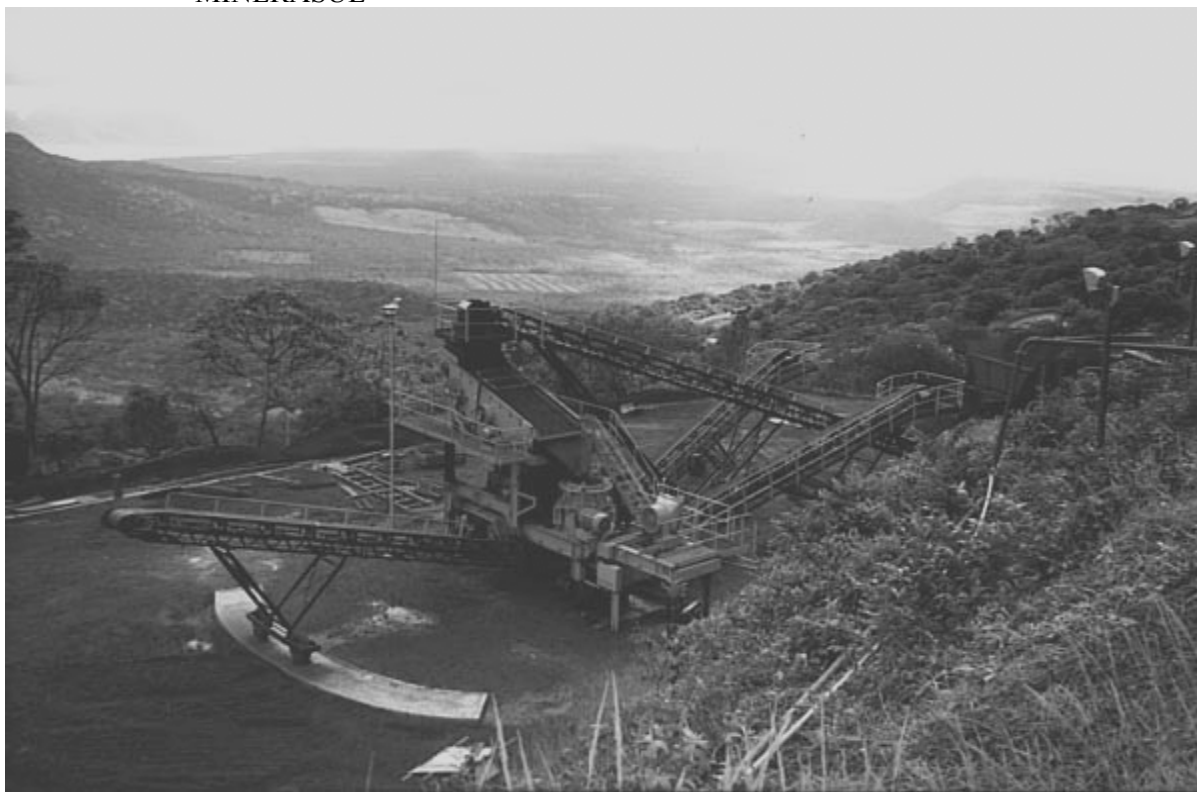
FIGURA 23 - ÁREA DE BENEFICIAMENTO DO MINÉRIO DE FERRO DA MINERASUL
